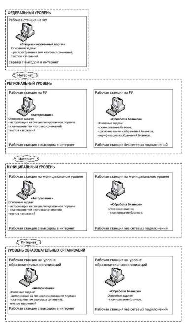
Рисунок 1. Архитектура и состав ПО
